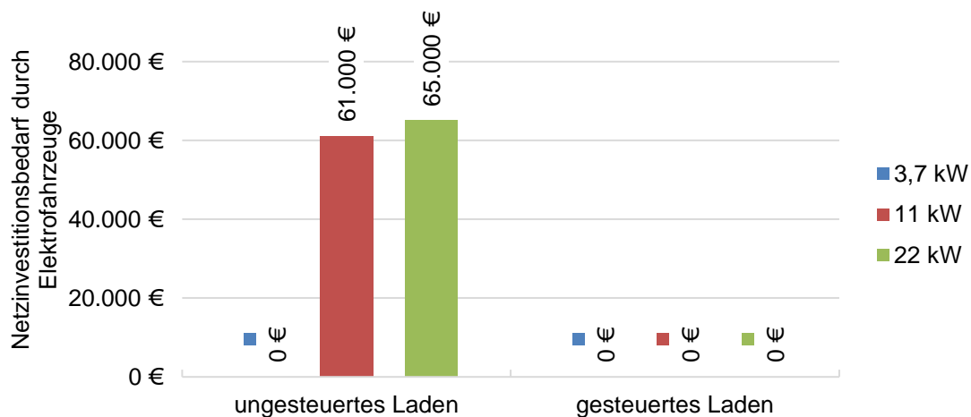
Abbildung 12: Investitionsbedarf für das Netz aus Abbildung 11 in Abhängigkeit der Elektrofahrzeugdurchdringung und der Ladeleistung der Fahrzeuge
