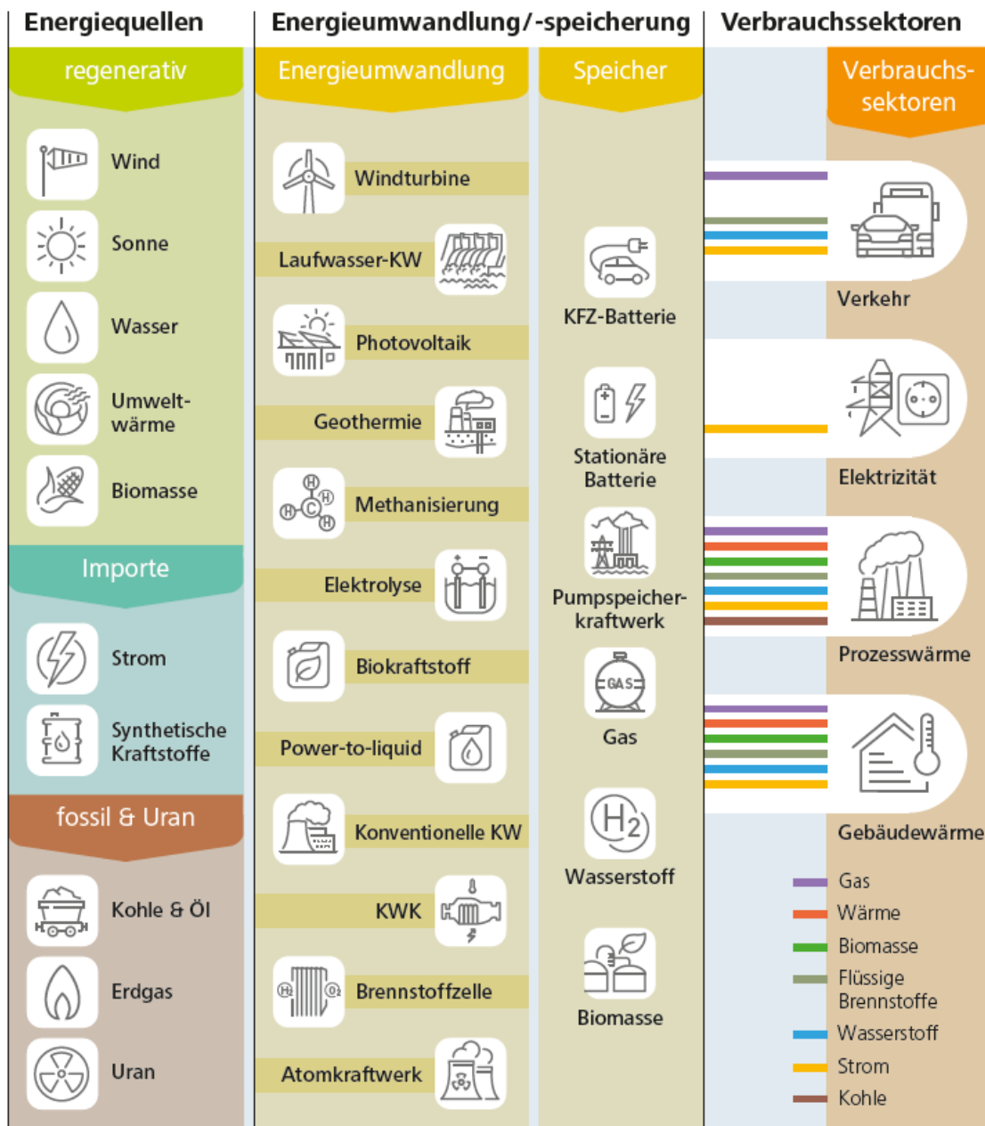
Abbildung 10: Schematische Darstellung des in REMod-D abgebildeten Energiesystems ohne die Darstellung der Subsysteme für Wärmeversorgung von Gebäuden und Verkehr (Quelle: Fraunhofer ISE)
